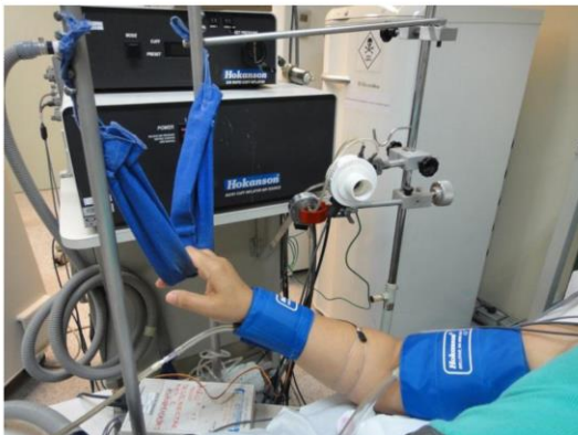
Figura 13 - Avaliação do fluxo sanguíneo muscular do antebraço por pletismografia de oclusão venosa. A) Posicionamento do braço, manguitos e silástico. B) Sinal de onda do fluxo sanguíneo muscular do antebraço.
