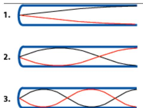
Figura 18 – Representação de modos de vibração de uma coluna de ar em um tubo cilíndrico fechado-aberto
