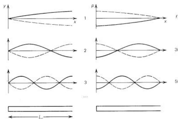
Figura 19 – Representação de modos de vibração com sua outra “metade” para visualizar a oscilação.
