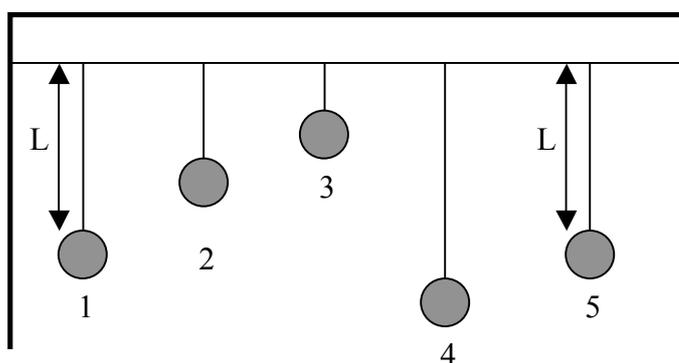
Figura 23 – Pêndulos justapostos mostrando a transferência de energia entre um pêndulo e outro com o mesmo comprimento.
