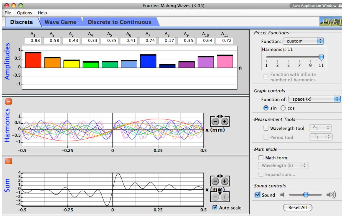
Figura 17 – Tela do software *Fourier: Making Waves* mostrando uma onda (em preto) gerada pela soma de 11 harmônicos (coloridos).
