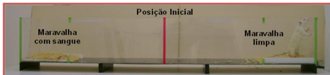
Figura 14 – Aparato utilizado para o experimento de preferência olfatória na idade adulta no DPN 90. O aparato foi dividido com marcações na parte externa da caixa de acrílico.
