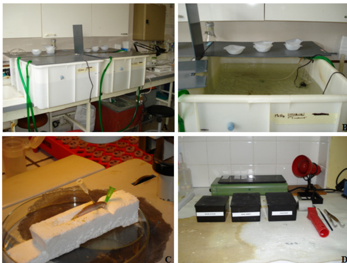
Figura 21 - Desenho experimental para Danio rerio realizado no Laboratório de ecofisiologia e ecotoxicologia dos sistemas aquáticos da Universidade de Bordeaux - França. A: Tanques de PVC utilizados durante o experimento. B: Tanques com aeração, oxigenação e temperatura controlada. C: Exemplar de Danio rerio anestesiado para a remoção do material utilizado nas análises. D: Bateria de reagentes utilizados na técnica de autometalografia.
