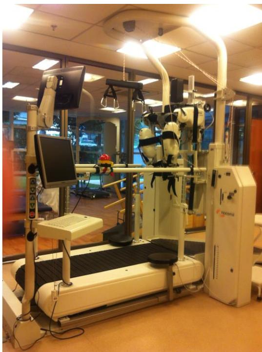
Figura 1 – Imagem do equipamento de treino de marcha robótica - Lokomat. (Fonte: Instituto de Reabilitação Lucy Montoro).
