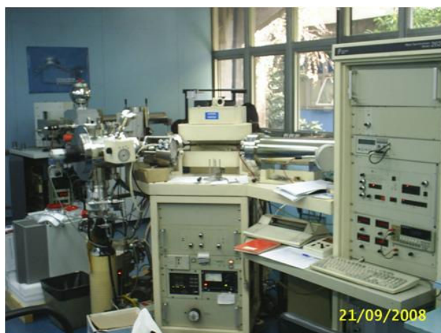
Figura 5.13 – (a) Foto do Espectrômetro de massas por termo ionização com multi-coletor Finnigan MAT262; (b) Esquema ilustrando os principais componentes (91) .
