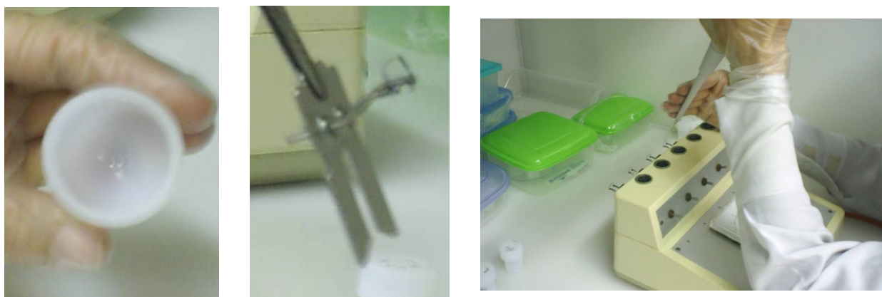
Figura 5.12 – (a) frasco Savillex® contendo amostras seca; (b) filamento de rênio e (c) etapa de deposição das amostras purificadas nos filamentos.
