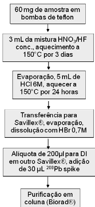
Figura 5.9 – Fluxograma das etapas do procedimento de dissolução total das amostras.
