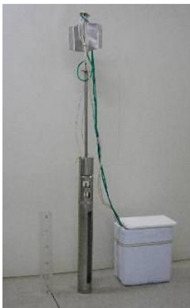
Figura 5.6 – Testemunhador de sedimentos tipo “core” utilizado no trabalho.
