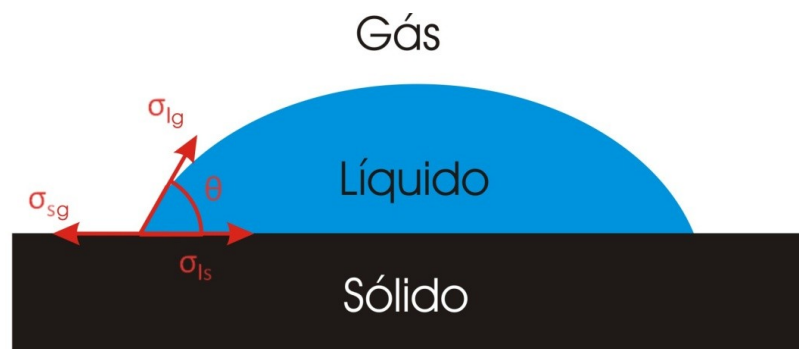
Figura 26 – Ângulo de contato \theta de um líquido sobre um sólido em meio gasoso.
