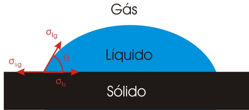
Figura 26 – Ângulo de contato \theta de um líquido sobre um sólido em meio gasoso.
