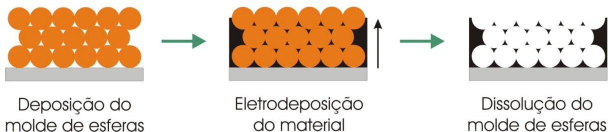
Figura 6 - Representação esquemática da eletrodeposição de um material sobre um eletrodo modificado com um molde coloidal de partículas esféricas.
