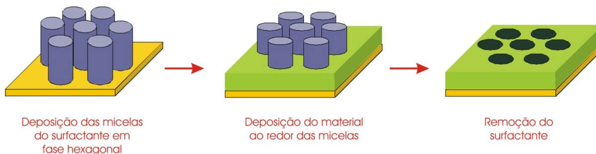
Figura 9 - Representação esquemática da deposição de um material utilizando micelas de surfactante em fase hexagonal como molde.
