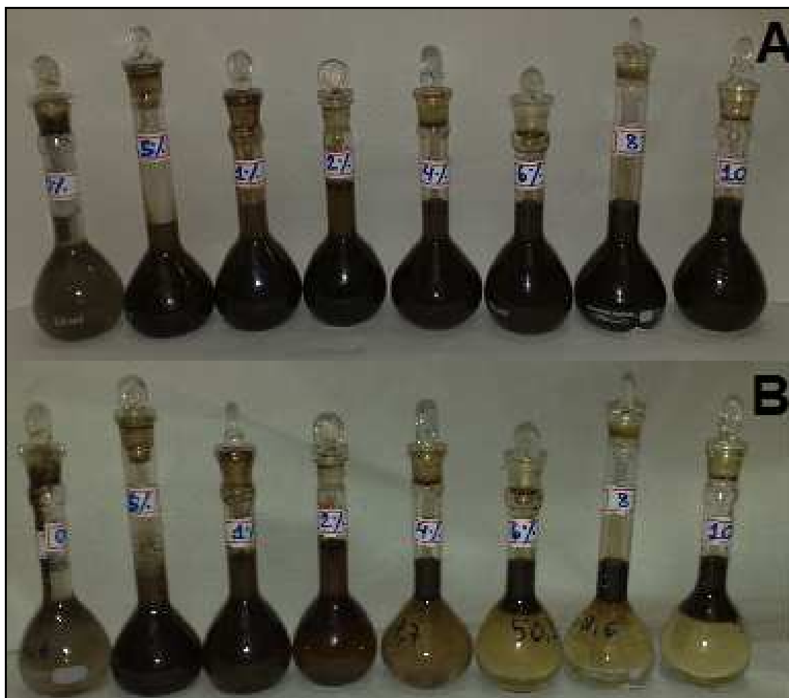
Figura 6. Fotografias de emulsões com 100 mg de óleo cru, 6% ( \text{m v}^{-1} ) de Triton X-100 ® e diferentes concentrações de hexano: 0; 0,5; 1; 2; 4; 6; 8 e 10% ( \text{v v}^{-1} ): (A) t = 0 min. e (B) t = 30 min.
