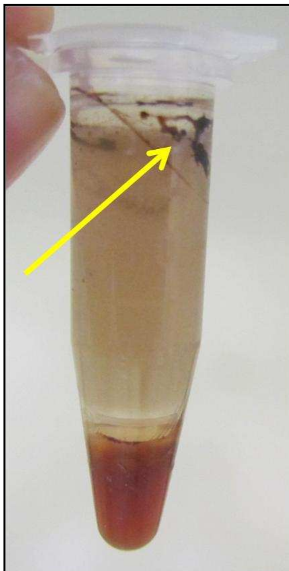
Figura 19. Influência da centrifugação a 1000 rpm sobre a separação das fases após CPE.
