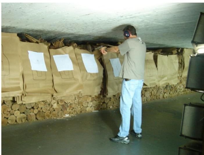
**Figura 6:** Foto do procedimento adotado para a coleta de resíduos de disparo de armas de fogo em anteparos.
