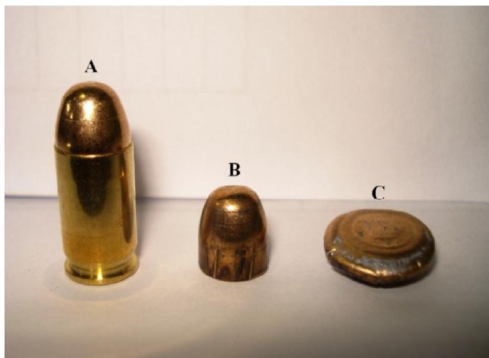
**Figura 45:** Foto de munições calibre .45. Projétil e estojo (A); projétil (B); projétil deformado após impacto (C).
