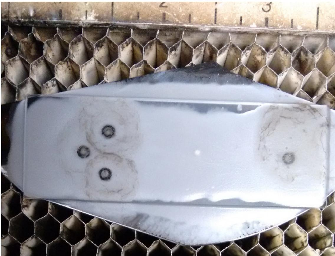
**Imagem da lâmina de vidro recoberta com parafina após corte dos círculos (reservatórios) e canais usando a cortadora a laser de CO<sub>2</sub>**
