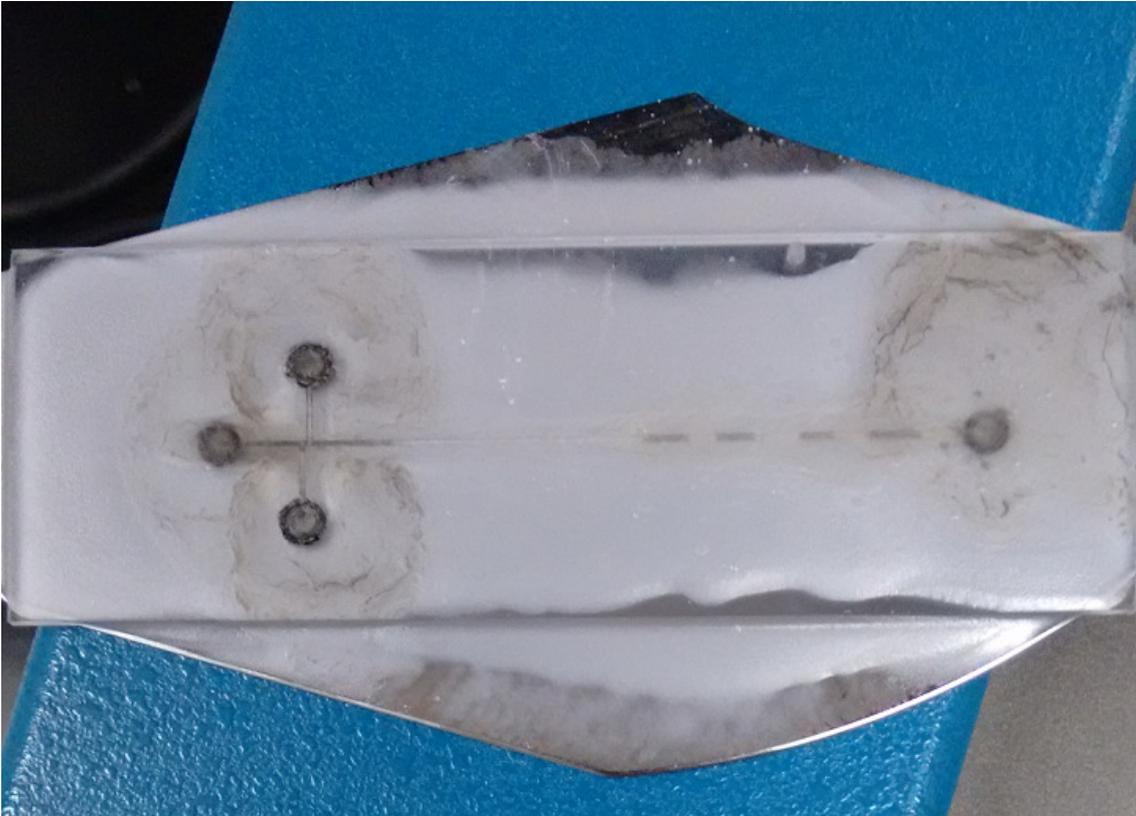
**Imagem da lâmina de vidro após corte dos círculos (reservatórios) e canais usando a cortadora a laser de CO<sub>2</sub>**
