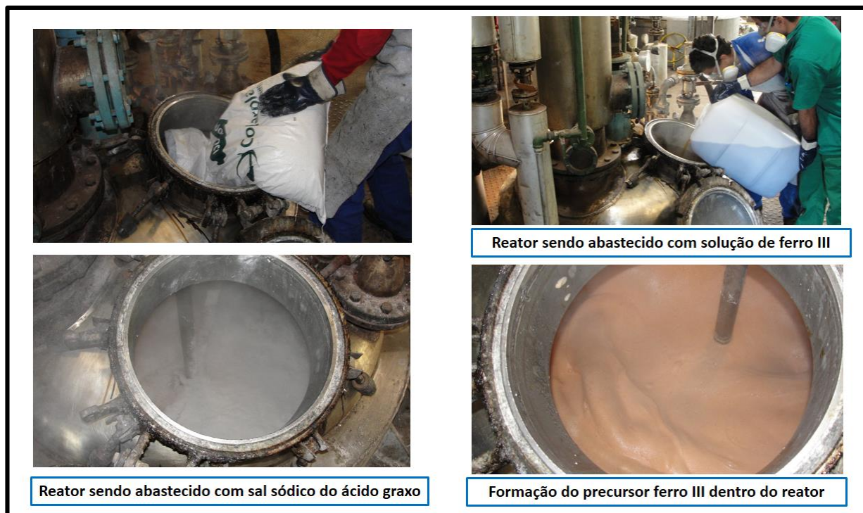
Figura 28. Adição dos reagentes e a formação do precursor de ferro.
