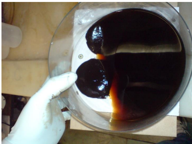
Figura 26. Decantação magnética das nanopartículas – processo de purificação.
