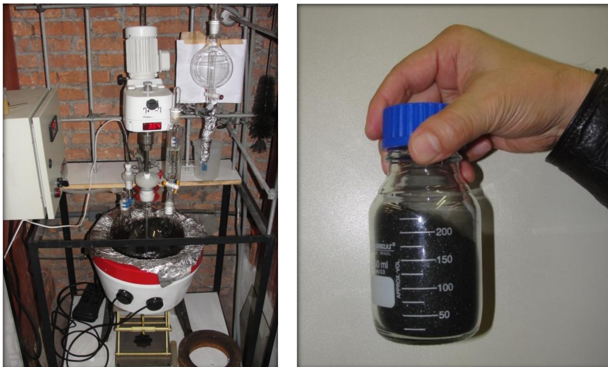
Figura 40. (Esquerda) Reator de 10 litros em uso no LQSN para produção de amostras. (Direita) Amostra contendo aproximadamente 500 g de nanopartículas enviada à Petrobrás
