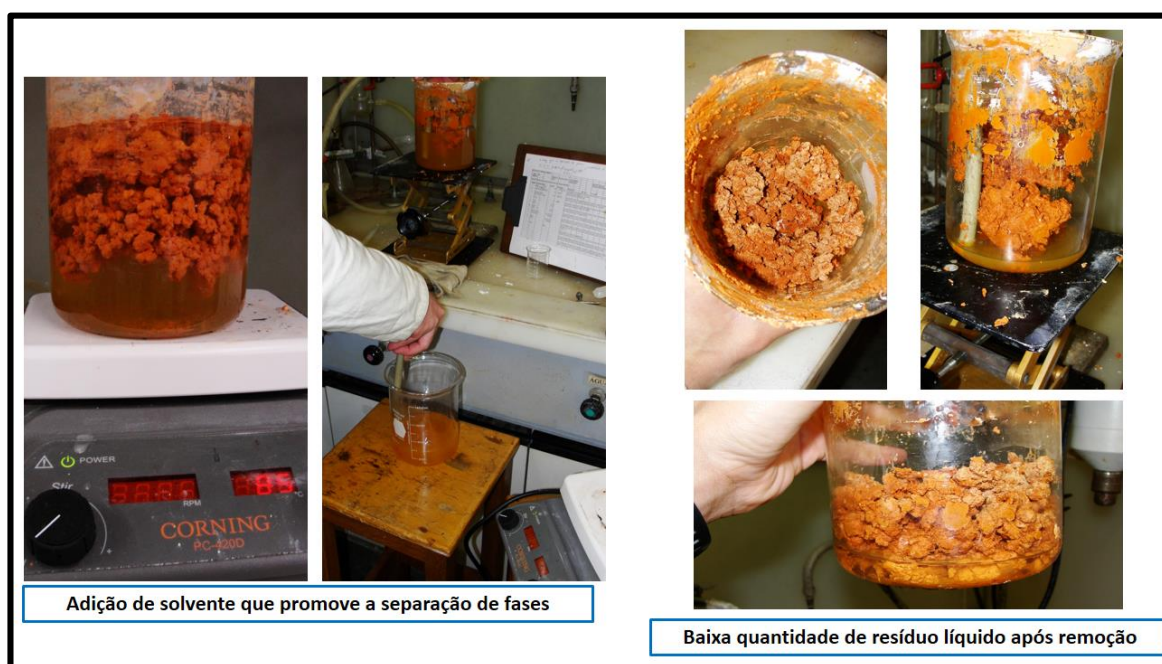
Figura 33. Novo processo de preparação do precursor de ferro III, que promove a separação de fases, eliminando a etapa de filtração – possibilidade de retirada do resíduo por debaixo do reator
