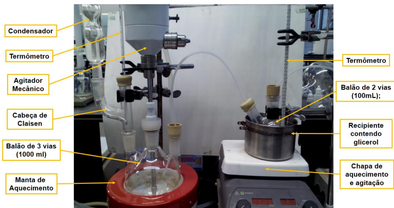
Figura 44. Arranjo experimental usado na síntese da NPMag@CMC
