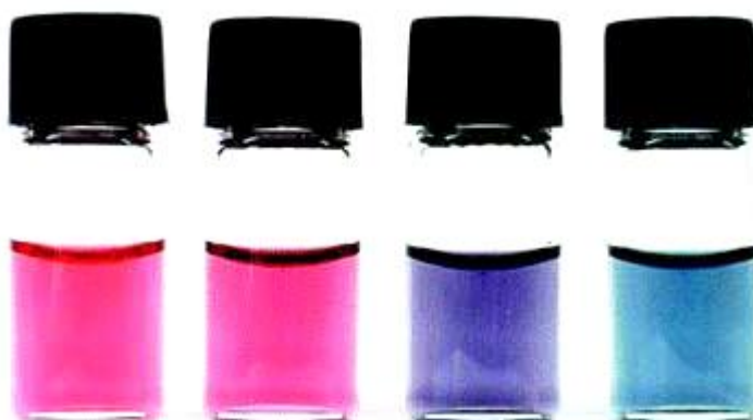
Figura 1: Suspensões aquosas de nanopartículas de ouro com tamanhos variados, aumentando da esquerda para a direita (Kim e Lee, 2009).
