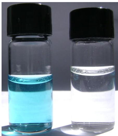
Figura 5.23 – Comparação entre solução do sal de ftalocianina de cobre 10 \mu\text{mol L}^{-1} antes (à esquerda) e após (à direita) o processo de foto-degradação por foto-Fenton. Condições de foto-degradação conforme o ensaio número 10 da superfície de resposta.
