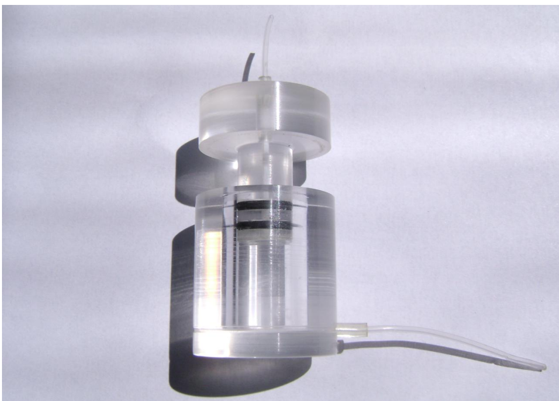
Figura 3.3 – Câmara de diluição para o experimento de degradação da ftalocianina. Nota: por simplicidade, o agitador e a barra magnética não aparecem na figura. Diâmetro do compartimento interno = 1,3 cm; altura = 3,0 cm.
