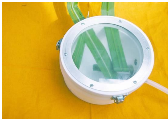
Figura 4: Sistema de coleta ( cuvette ) para emissões de compostos da planta.
