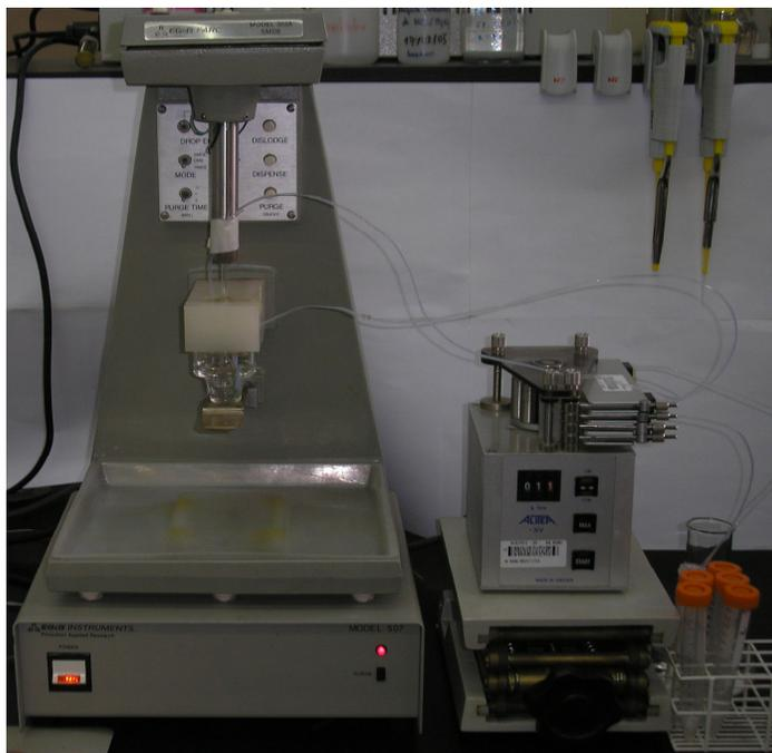
Figura 7- Potenciostato 263 A da EG&G acoplado ao Eletrodo de mercúrio, modelo 303A, EG&G PAR e bomba peristáltica Alitea XV.
