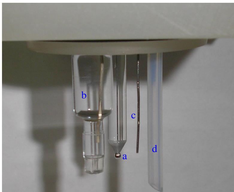
Figura 5- (a) Eletrodo de gota pendente de mercúrio (HMDE), (b) eletrodo de referência Ag/AgCl, (c) eletrodo auxiliar de platina e (d) tubo usado para desaerar a solução com N<sub>2</sub>.
