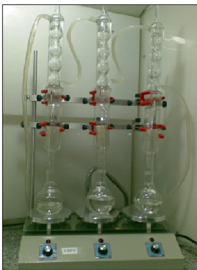
Figura 7. Extração por Soxhlet dos hidrocarbonetos presentes no MP 10 .
