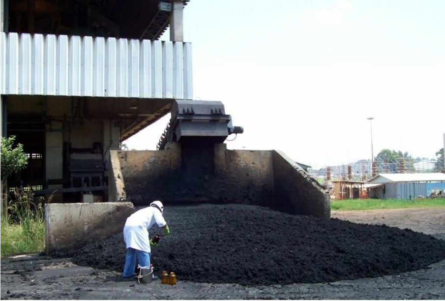
Figura 4: Local de coleta na ETE da RMSP após o processo de desaguamento em filtros prensas de placas o lodo final produzido vai para uma esteira que o descarrega nesse pátio de onde é recolhido para destinação final.
