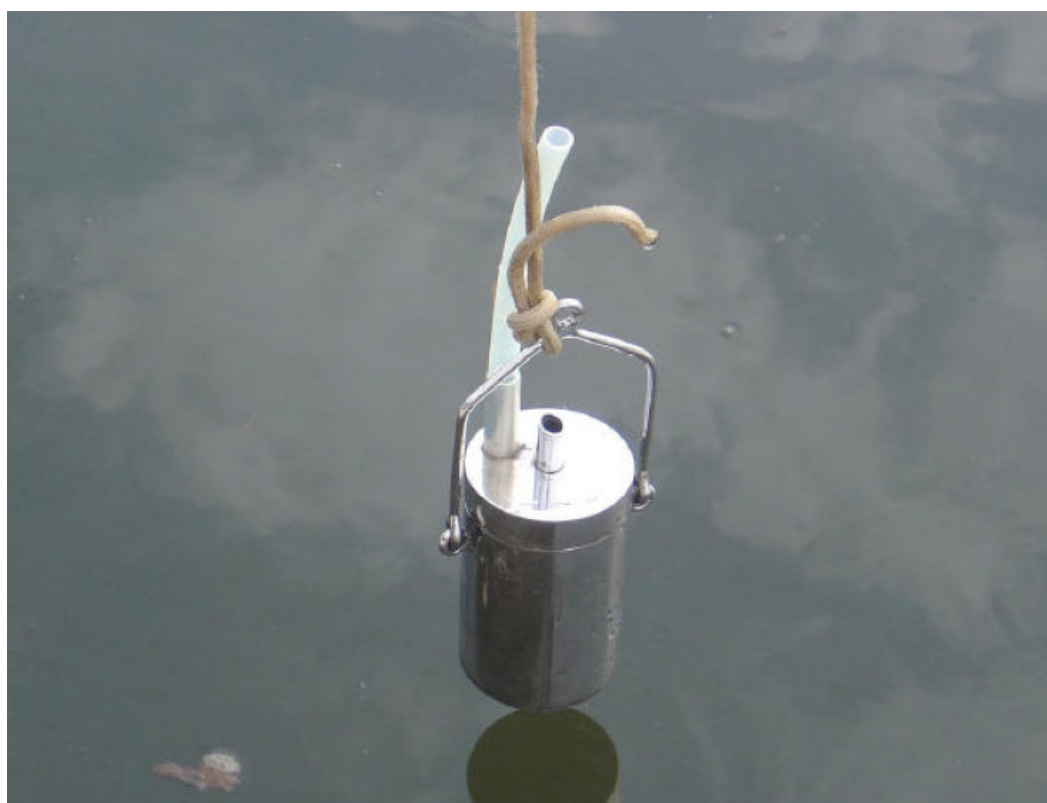
Figura 18 – Coleta de amostra de água com auxílio de batacafo de aço inox
