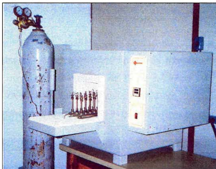
Figura 3.3 – Etapa de limpeza dos cartuchos de adsorção.
