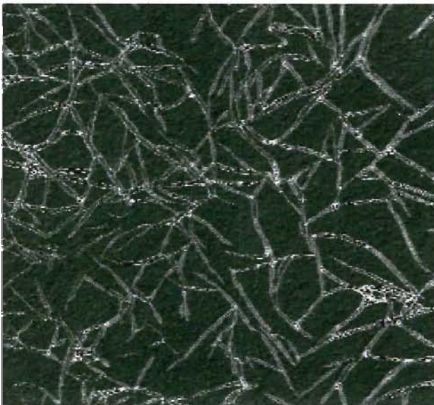
Figura 4.12: Micrografia obtida em MEV de parte de um filme com 5 % F suportado sobre ouro, em duas magnificações: 350 (a) e 3500 (b) vezes. É possível observar a morfologia do substrato, que pode ser visto porque o filme formado é transparente.
