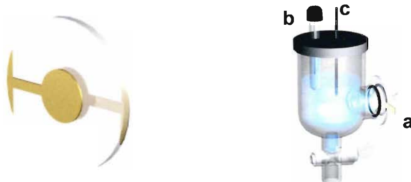
Figura 3.1.2: Cristal de quartzo com depósito de ouro e célula eletroquímica utilizada nos experimentos de MECQ, onde a é o cristal de quartzo recoberto com Au utilizado como eletrodo de trabalho, b eletrodo de referência e c eletrodo auxiliar [100].
