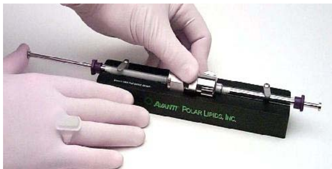
Figura 13 – Extrusor utilizado para a obtenção de LUVs (Ahyayauch, et al., 2006).
