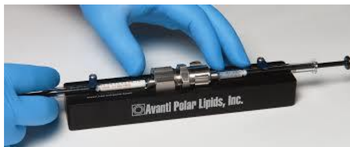
Figura 12- Extrusão de MLV para se obter vesículas unilamelares grandes, LUV.
