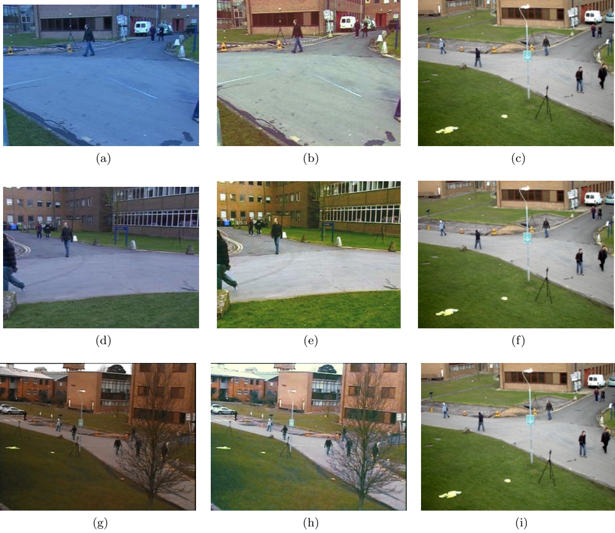
Figura 4.6: Resultados da correção de cor e brilho para imagens de teste com os parâmetros T_0 = 256 , K = 100 , \epsilon = 10^{-5} . A coluna da esquerda mostra as imagens a serem corrigidas, a coluna da direita mostra a imagem usada como referência para a correção e a coluna do meio mostra as imagens corrigidas.
