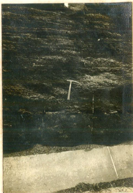
Foto nº 34 - Calcita recristalizada em planos de fratura. Nota-se nível calcífero sobrejacente. (Formação Estrada Nova. Rodovia Castello Branco, km. 160 - SP)
