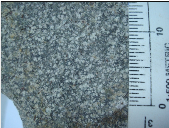
Figura 5.26 Textura de desvitrificação no riolito da Sequencia Santa Maria, com a formação de esferulitos (pontos brancos de até 1 mm de diâmetro)
