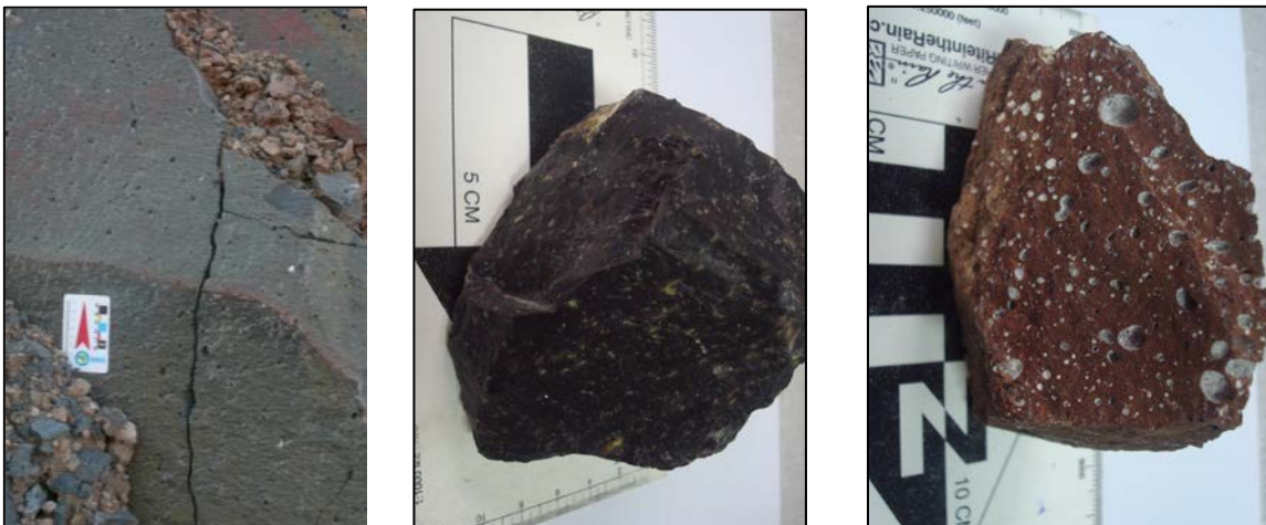
Fig. 6.1. As três variedades texturais que ocorrem na sequência Caxias do Sul. Cinza cristalino à esquerda, preto vítreo no centro, e marrom vesiculado à direita.
