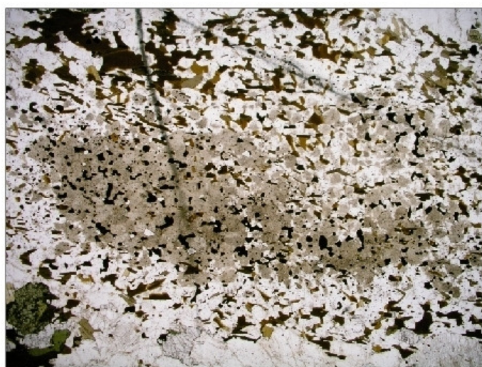
Fotomicrografia 46: Enclave diorítico fino com textura granoblástica, e intensa alteração sericítica no núcleo. Lado maior da foto 10,4 mm.
