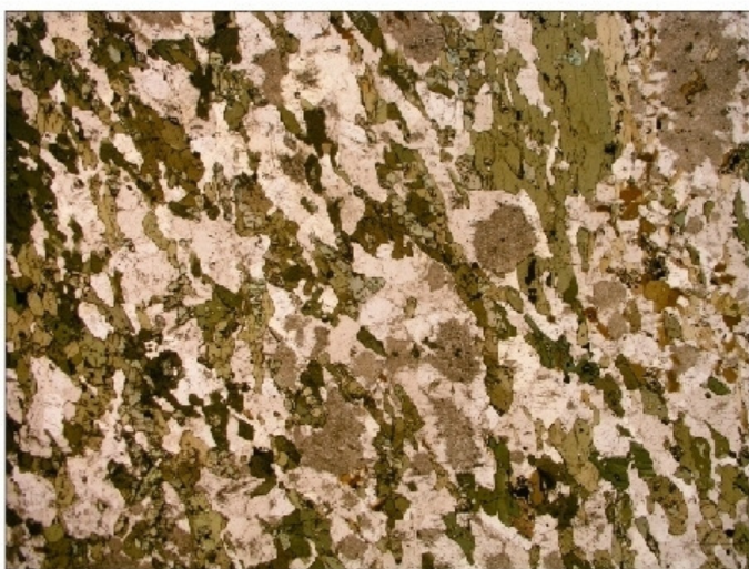
Fotomicrografia 50: Enclave diorítico com clinopiroxênio, hornblenda, plagioclásio, biotita, opacos e titanita. Lado maior da foto 3,25 mm.
