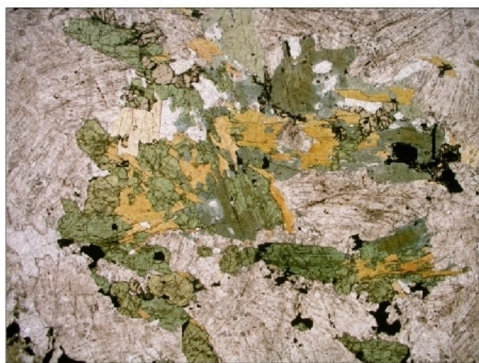
Fotomicrografia 6: Assembléia máfica de sienito com egerina-augita, hornblenda, biotita, apatita titanita, além de opacos hematita e magnetita. Lado maior da foto 10.4 mm.
