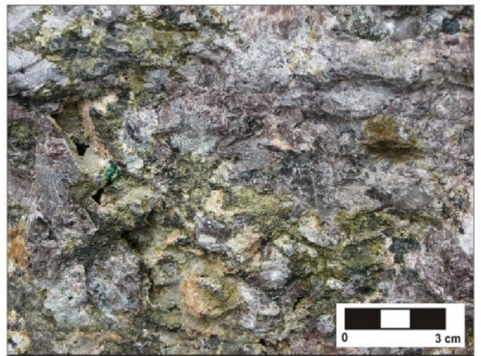
Foto 8 (PB-174): Intensa alteração hidrotermal em sienito grosso. Presença de cavidades miarolíticas e carbonato e malaquita tardios.
