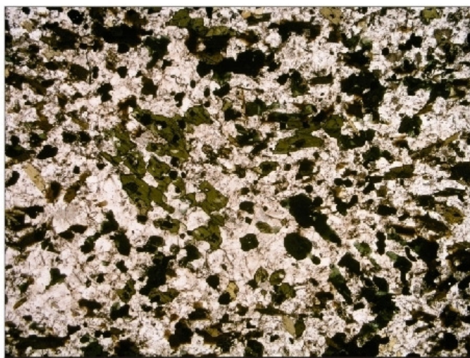
Fotomicrografia 44: Monzonito com feldspato alcalino pertítico, plagioclásio, hornblenda, biotita, apatita e opacos. Lado maior da foto 2,60 mm.
