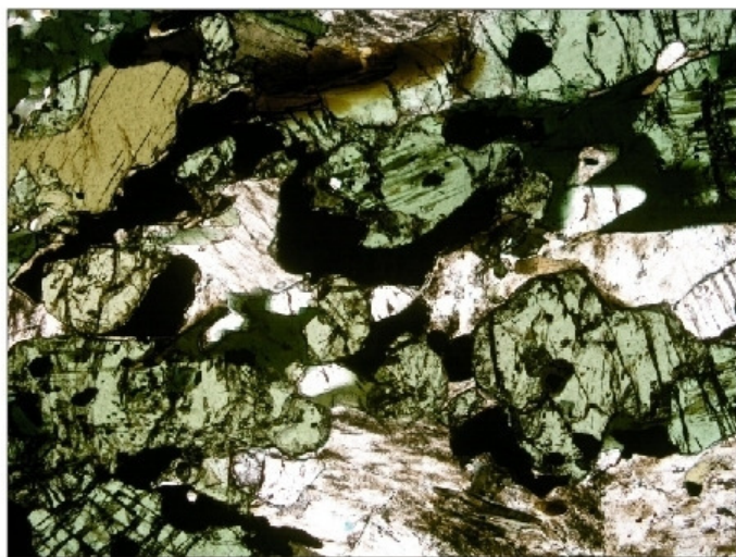
Fotomicrografia 29: Associação típica de cumulato máfico em SLS com diopsídio, biotita, minerais opacos e feldspato alcalino. Lado maior da foto 8,32 mm.
