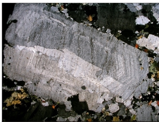
Fotomicrografia 40: Zoneamento oscilatório em feldspato alcalino pertítico. Lado maior da foto 10,4 mm.
