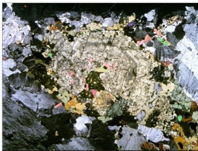
Fotomicrografia 39: Zoneamento composicional em cristal de diopsídio. Lado maior da foto 5,2 mm.
