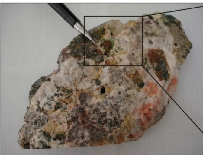
Foto 9: Veio pegmatítico tardio com intensa alteração hidrotermal. Paragênese exótica com K-feldspato, apatita, magnetita, carbonato, calcopirita e malaquita.
