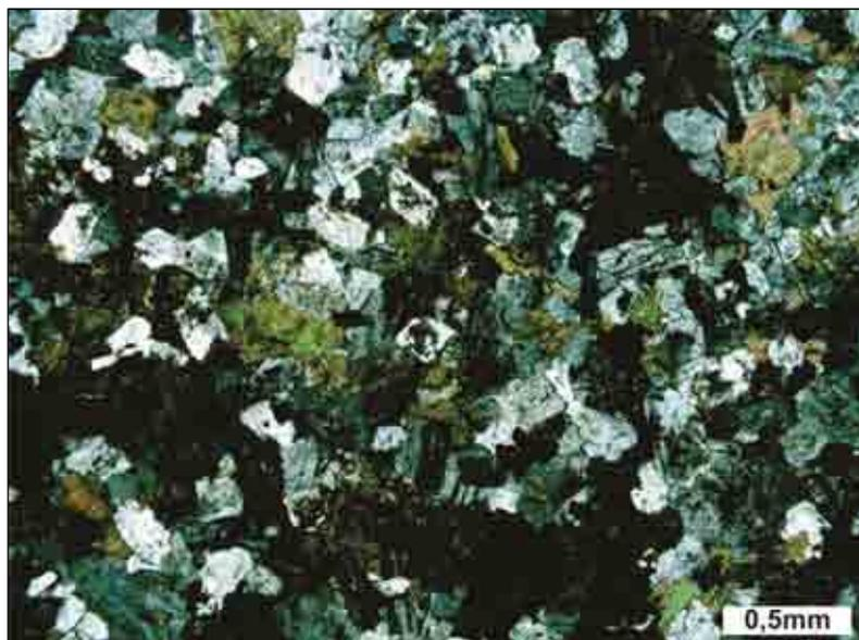
**Fotomicrografia 39** – Aspecto “sujo” resultante da alteração do enclave máfico. Polarizadores X.
