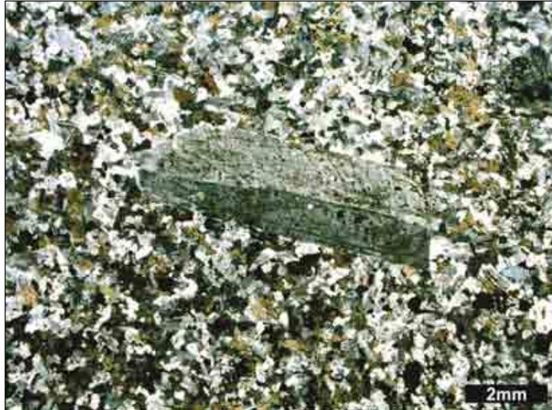
**Fotomicrografia 36** – Xenocristal de plagioclásio com bordas arredondadas no enclave máfico. Polarizadores //.
