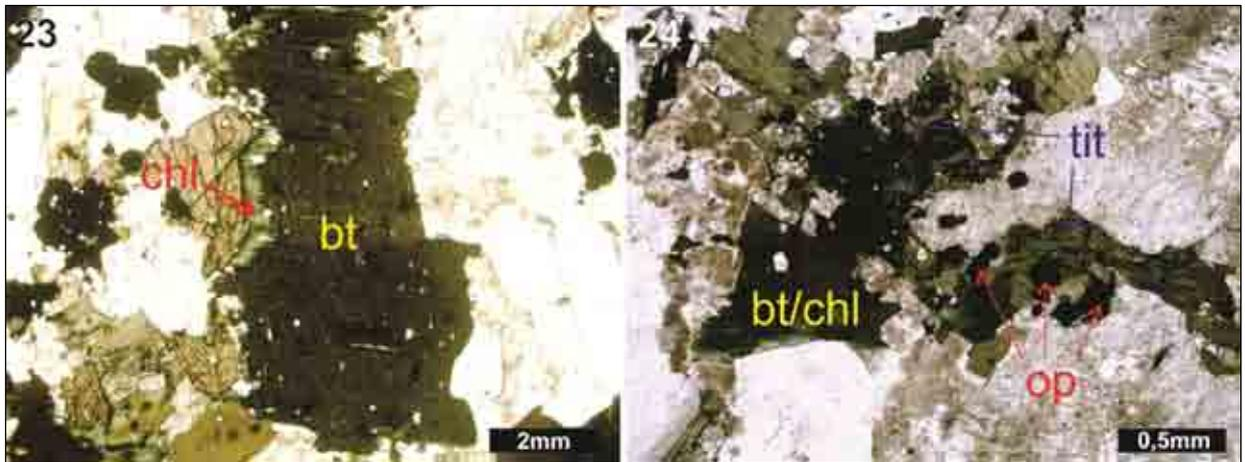
**Fotomicrografias** – (23) Biotita sendo substituída por clorita. Polarizadores //; (24) Associação típica de máficos. Polarizadores // (bt = biotita; chl = clorita; tit = titanita; op = opaco).
