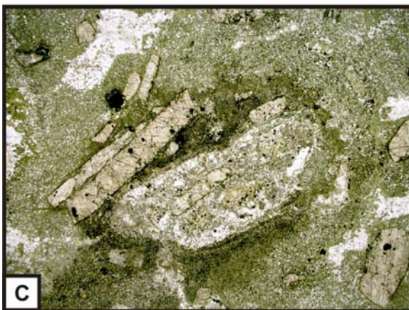
C: Amostra PPE-7Aa. Luz plano-polarizada. Enclave máfico-ultramáfico "porfirítico". Pseudomorfo de clinopiroxênio com acúmulo de magnetita, clinopiroxênio verde-oliva e flogopita ao seu redor. Lado maior da foto = 10,2mm.
