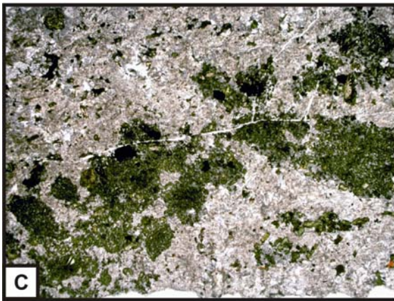
C: Amostra PPE-31. Luz plano-polarizada. Glomérulo máfico presente no enclave microgranular félsico. Acúmulo de clinopiroxênio e magnetita, com alguns cristais maiores deste. Lado maior da foto = 10,2mm.
