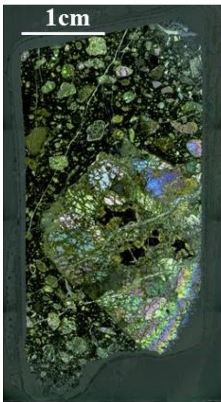
Figura 91 – Imagens de microscópio óptico e de MEV da amostra Fo-5, de dunito com textura protogranular com bolsões de flogopita com cromita e clinopyroxênio secundário associado. 1- detalhe do bolsão de flogopita com cromita homogênea com clinopyroxênio nas clivagens e na borda.
