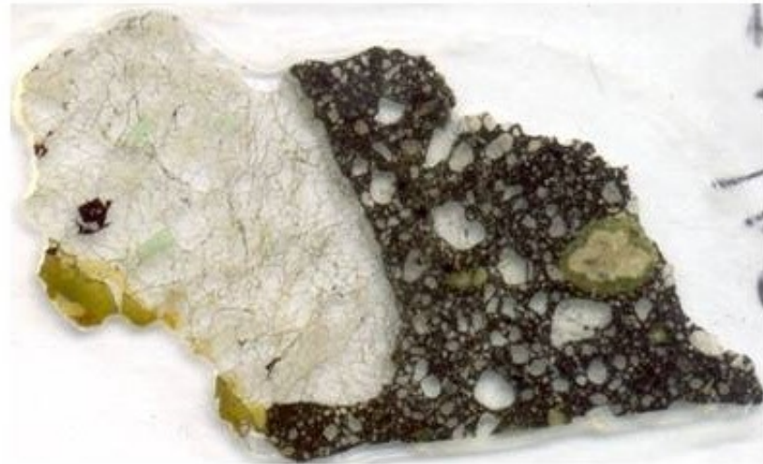
Figura 61 – Imagens de microscópio óptico e da amostra In1-10, de harzburgito porfiroclástico com espinélio, com veio de serpentina à esquerda, em meio a matriz kimberlítica rica em macrocristais de olivina.
