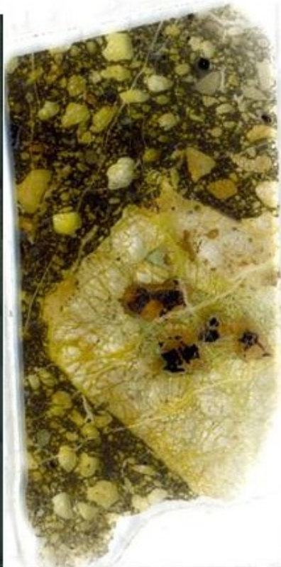
Figura 91 – Imagens de microscópio óptico e de MEV da amostra Fo-5, de dunito com textura protogranular com bolsões de flogopita com cromita e clinopyroxênio secundário associado. 1- detalhe do bolsão de flogopita com cromita homogênea com clinopyroxênio nas clivagens e na borda.
