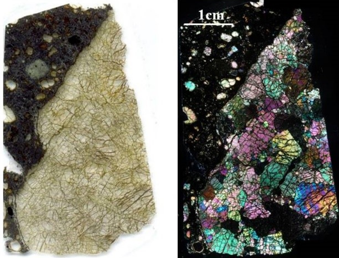
Figura 79 – Imagens de microscópio óptico e de MEV da amostra Lm1-29, de dunito composto somente por olivina, e serpentina nas fraturas, em meio a matriz kimberlítica.
