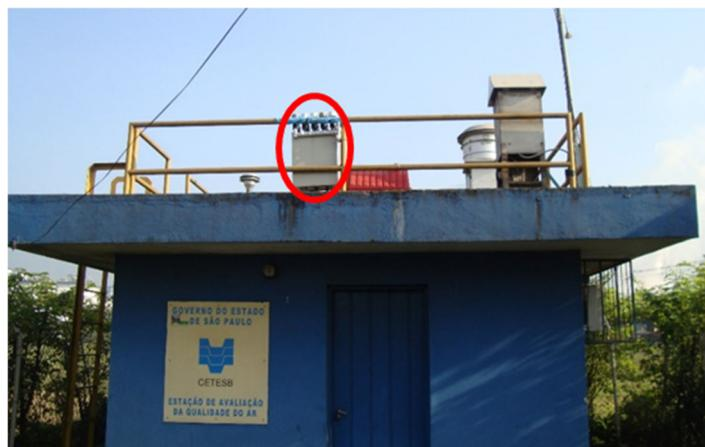
**Figura 3.2** – Foto do local de coleta de material particulado na Vila Parisi, cidade de Cubatão. O círculo em vermelho indica o amostrador automático do tipo AFG.
