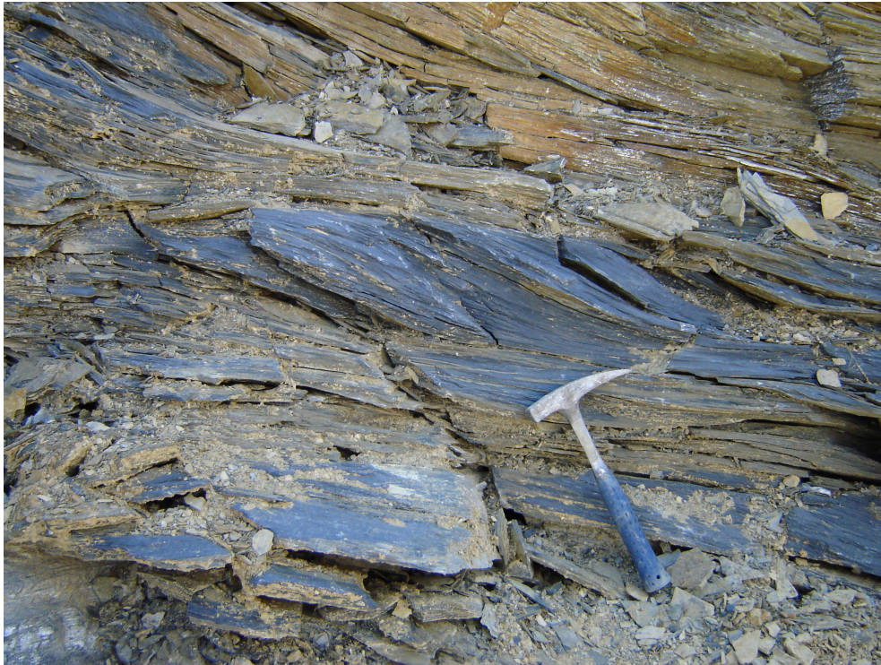
Fotografia 4 - 32. Pares S/C evidenciam planos de cisalhamentos com vergência exclusiva para W (N7735577/E0528226 UTM SAD69/21S).
