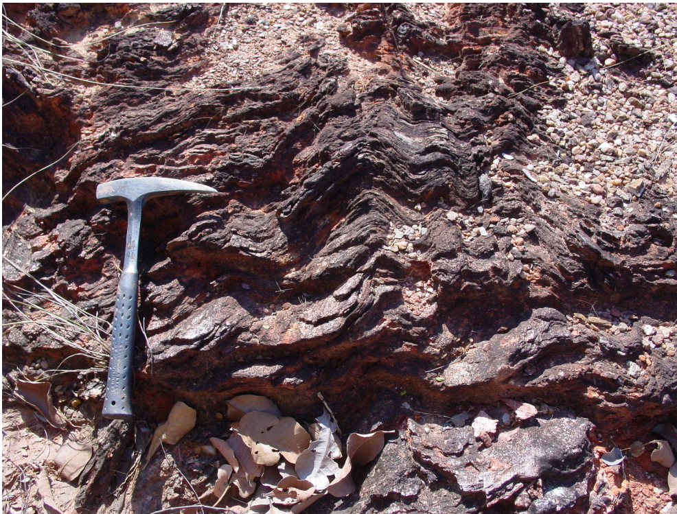
Fotografia 4 - 9. Xisto muito intemperizado exibindo foliação dobrada (UTM: 591424; 7748422 - UTM - SAD69/21S).
