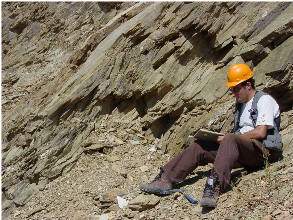
Fotografia 4 - 33. Filito de coloração cinza esverdeado, milimetricamente bandados (N7735198/E0528308 UTM SAD69/21S).
