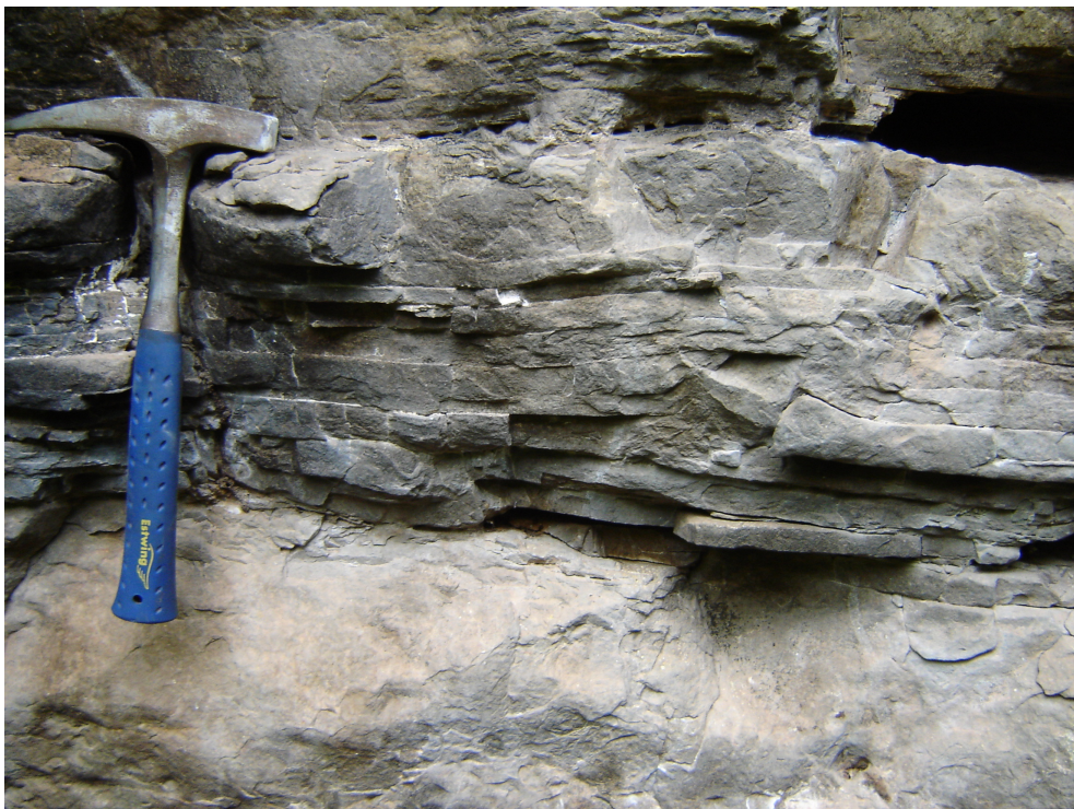
Fotografia 4 - 18. Calcarenito dolomítico estratificado, com intercalações de porções mais maciças (N7730447/E0510534 UTM SAD69/21S).
