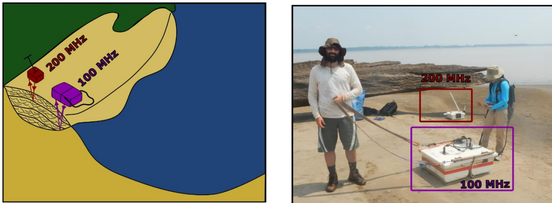
Figura 27: À esquerda esquema de aquisição e penetração de cada antena e à direita foto mostrando o tamanho real dos equipamentos.
