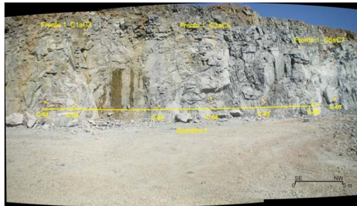
Figura 5.2: Área de análise de direção NW-SE ilustrando o posicionamento da scanline 1, Frente 1_C1aC3, Frente 1_C3aC5 e Frente 1C5aC7
