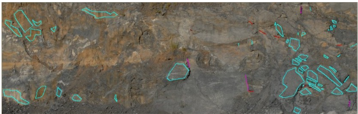
NE SW Figura 5.32: Imagem da Frente 2 com os planos e traços das discontinuidades /: Família I /: Família II /: Família III
