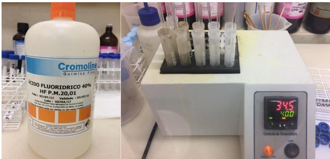
Figura 14. Amostras em bloco aquecedor com HF para remoção da sílica presente no sedimento. Fotos: Cynthia Ramos.
