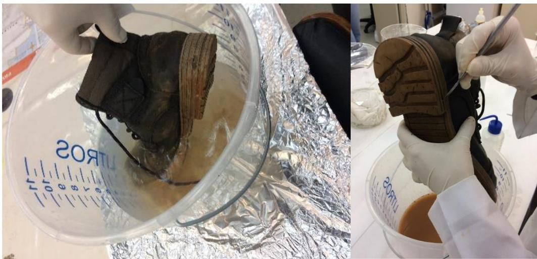
Figura 13. Processo de extração dos resíduos das botas em béquer com água destilada, com auxílio de espátula em laboratório. Fotos: Cynthia Ramos.
