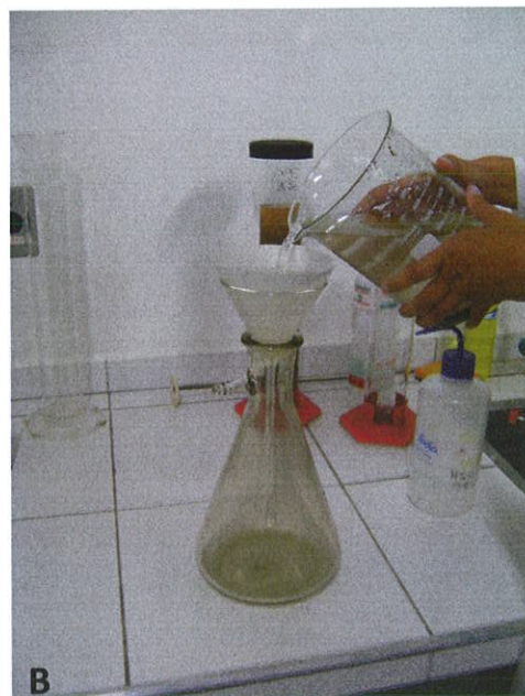
Figuras 15 A e B- Ensaio granulométricos: pipetagem (A) e filtragem da areia após processo de elutriação (B).
