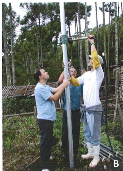
Figuras 11 A e B- Amostragem com vibrocore no ponto MV3, margem esquerda do Córrego do Cadete, e visão geral da área de coleta. O Córrego do Cadete margeia a falésia da imagem 11A, onde é evidente a presença de depósitos cascalhosos, atribuídos a transporte de encosta.
