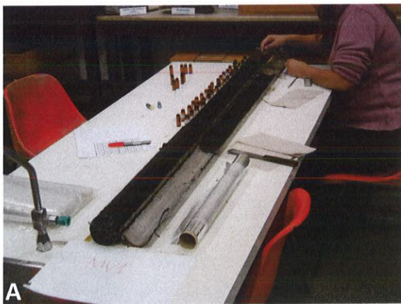
Figuras 12 A e B- Subamostragem de material para palinologia, a partir de testemunho: retirada de duas alíquotas de 1 cm 3 a cada 5 cm de coluna vertical.
