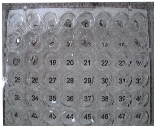
Figura 17 A e B- Preparação para leitura no espectrômetro de massa: pesagem das amostras (A), embaladas em seguida em papel alumínio e acondicionadas em placa numerada (B).
