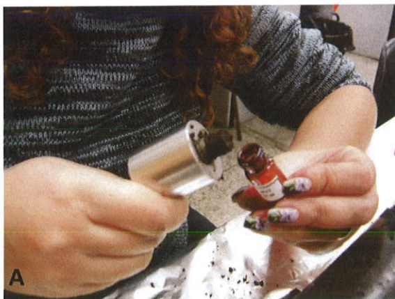
Figuras 13 A e B- Detalhe da subamostragem e do armazenamento das alíquotas para palinologia e datação em frascos de vidro com respectivas identificações.
