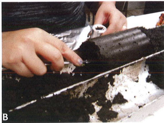
Figuras 12 A e B- Subamostragem de material para palinologia, a partir de testemunho: retirada de duas alíquotas de 1 cm 3 a cada 5 cm de coluna vertical.
