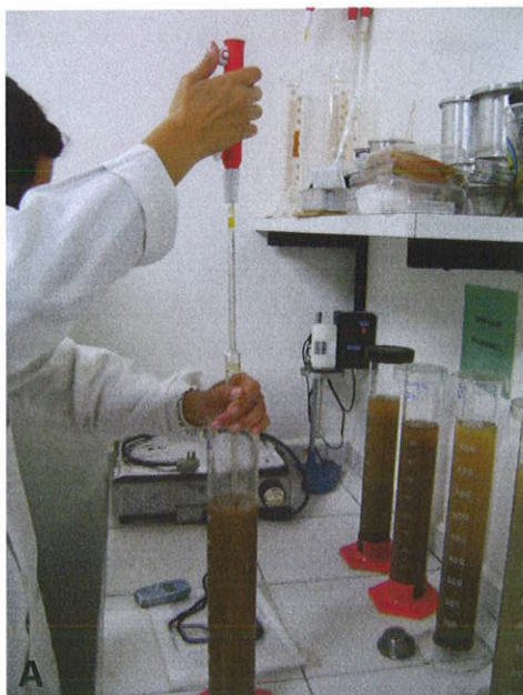
Figuras 15 A e B- Ensaio granulométricos: pipetagem (A) e filtragem da areia após processo de elutriação (B).
