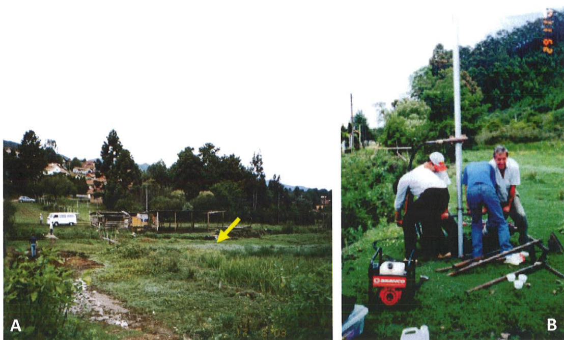
Figura 10 A e B- Amostragem com vibrocore no ponto MV2, margem esquerda do Córrego do Cadete (indicado pela seta amarela), e contexto de campo do ponto amostrado. Foto 10A obtida de norte para sul
