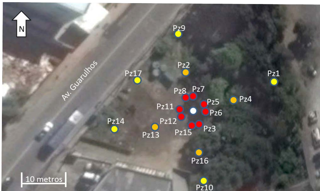
Figura 51 – Rede de monitoramento ao redor do poço GRU-001. Os poços em vermelho representam distância de até 5 m do poço de bombeamento; os poços em laranja representam distância de até 10 m e os poços em amarelo representam distância de até 20 m.
