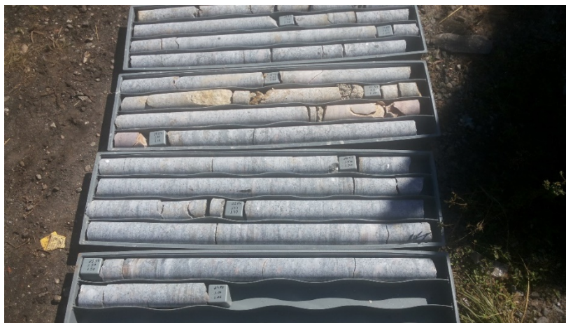
Figura 49 - Caixas de testemunhos da perfuração do furo guia do poço GRU-001
