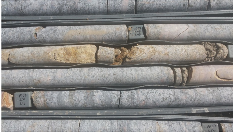
Figura 50 - Estruturas com evidência de fluxo de água no poço GRU-001.
