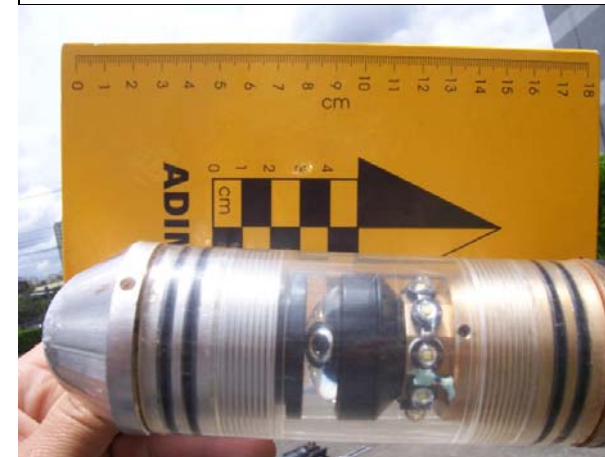
c) Detalhe da câmera e dos LEDs de iluminação do perfilador óptico
