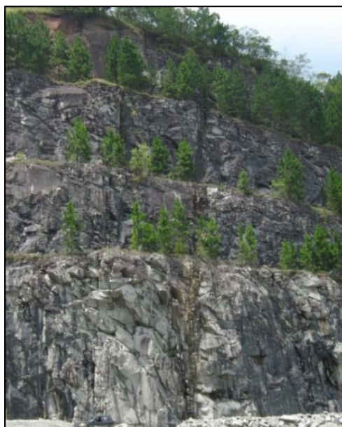
Figura 37 - GS-3, ponto U: zona de fratura do grupo NW (atitude média 58/90); notar os traços retilíneos e a grande continuidade (ocorre continuamente nas quatro bancadas visíveis neste local da pedreira)
