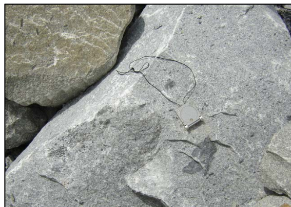
Figura 22 - Granito maciço, cinza claro, equigranular da pedreira GS-3
