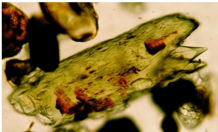
Figura 7 - Cristal de diopsídio (piroxênio) – mineral comum dentre os pesados nos sedimento - exibindo capas de argilomineral com óxido de ferro e feições de dissolução.
