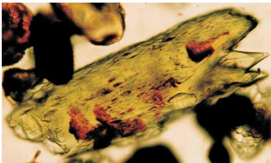
**Figura 5.** Cristal de diopsídio (piroxênio), mineral comum dentre os pesados nos sedimentos, exibindo capas de argilomineral com óxido de ferro e feições de dissolução.
