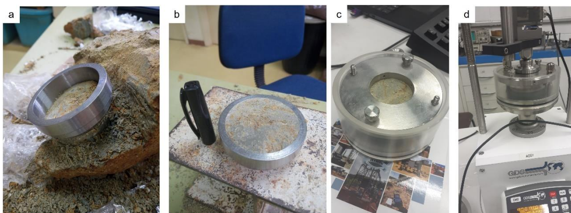
Figura 17 – a) molde do corpo de prova; b) corpo de prova moldado e inserido no disco metálico; c) amostra inserida em câmara para saturação e execução do ensaio
