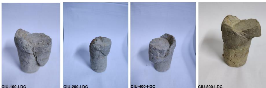
Figura 27 – Registro fotográfico dos corpos de prova após os 04 últimos ensaios triaxiais CIU
