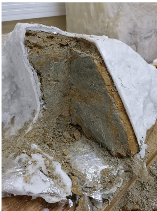
Figura 16 – Bloco retirado da parede escavação da Linha 6 do Metrô, já parafinado e aberto após molde de corpo de prova
