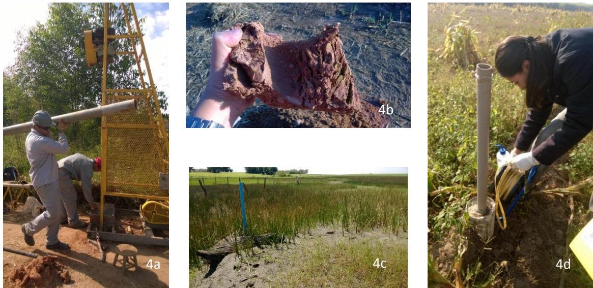
Figura 6a. Sondagem por trado mecanizado; 4b amostra do solo; 4c lago e 4d poço 20.
