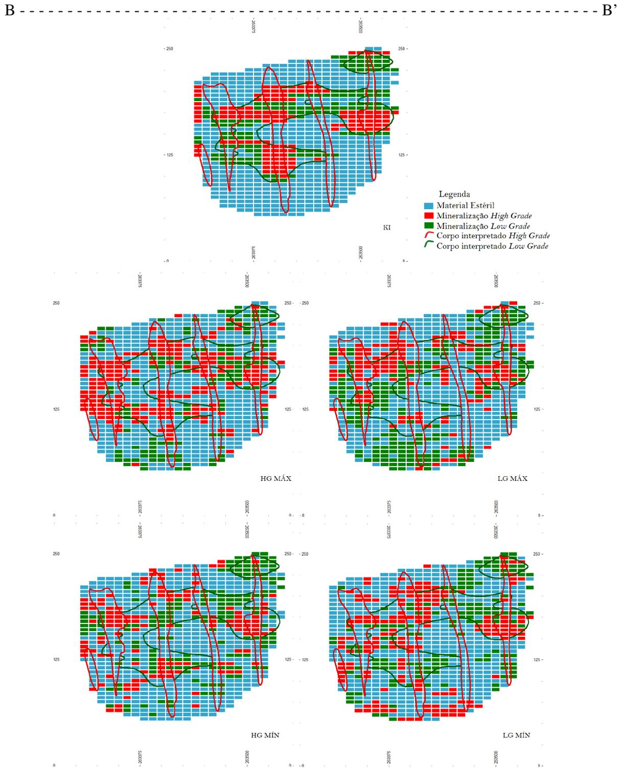
Figura 42 – Modelo de blocos da krigagem de indicadores e das realizações máxima e mínima obtidas por SIS, para os três tipos de material (HG, LG e Estéril) - seção  $y=6,576,240$
