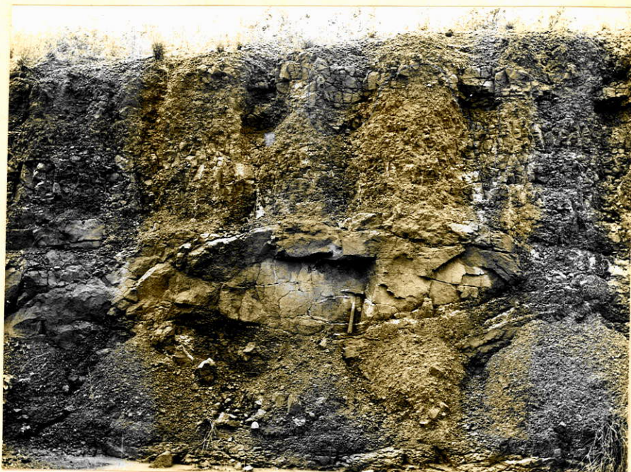
Fig. 21 - Lente de arenito intercalada em diamictito de matriz silto-argilosa. Rodovia Jardim-Bela Vista, km 74.
