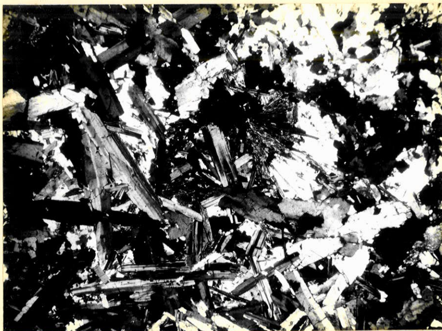
Fotomicrografia 13 - Cancrinita mariupolito. Albita, de hábito ripiforme e comumente geminada (branca a cinza escuro) em associação com egerina (agregado fibrorradial ocupando aproximadamente as partes centrais da foto) e Cancrinita (mineral xenomórfico de cor branca). Nícois cruzados. Aumento: 20 X.
