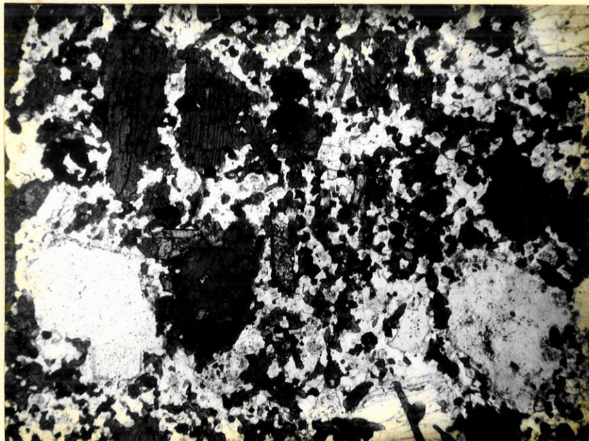
Fotomicrografia 11 - Melanita malignito. Cristais de melanita (grânulos pretos aproximadamente equidimensionais) e egiro-augita (cinza médio a escuro) em associação com nefelina (branca) e titanita idiomórfica (contorno losangular e relêvo alto). Nícois paralelos. Aumento: 20 X.
