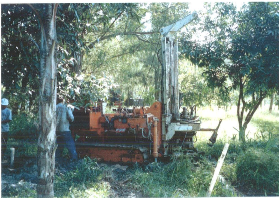
Figura 5: Perfuratriz rotativa hidráulica montada sobre esteiras.
