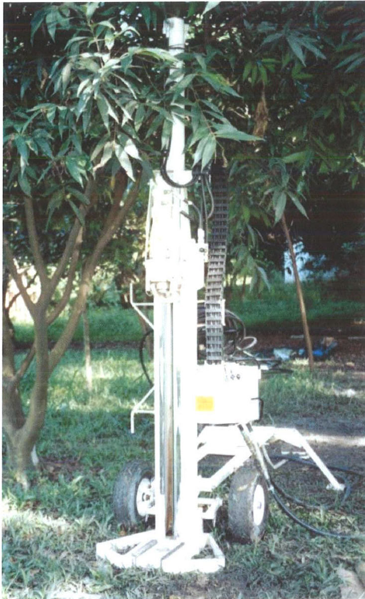
Figura 15: Máquina do tipo Geoprobe empregada para cravação do tubo amostrador.
