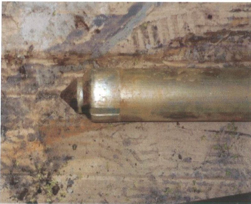
Figura 14: Tubo amostrador com ponteiros interna e externa.
