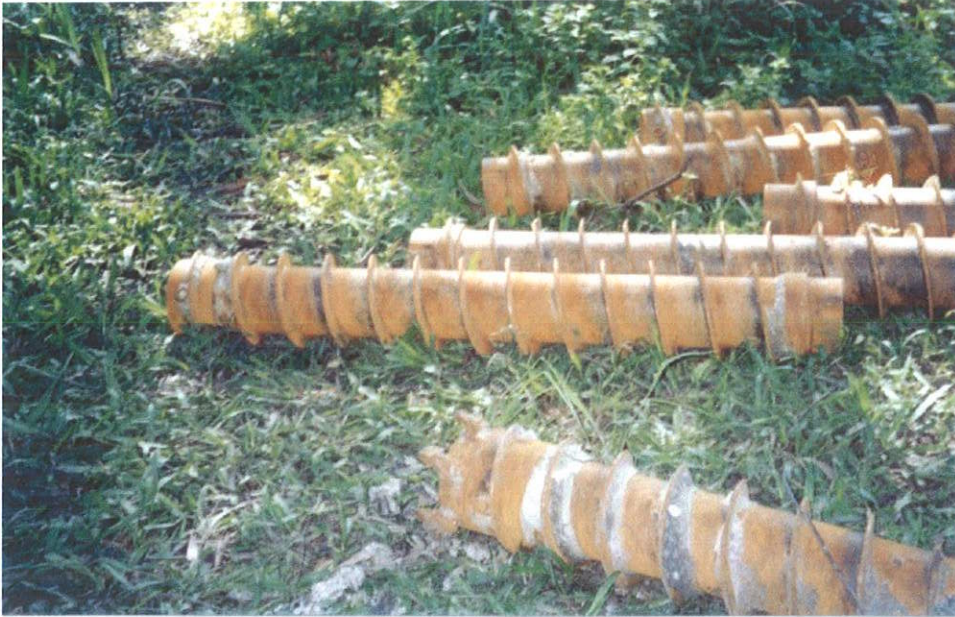
Figura 6: Trados ocos empregados na perfuração.
