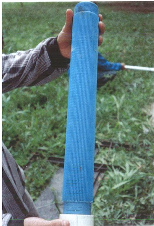
Figura 7: Seção filtrante do revestimento de PVC geomecânico de 50mm de diâmetro.
