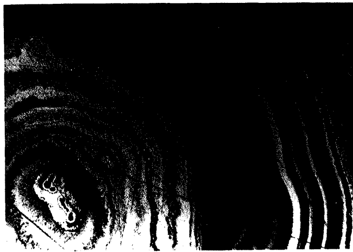
Foto 6 - Criptomelana coloforme, com bandas concêntricas em relação a um núcleo. Notar a diversidade de cor, desde cinza clara até cinza escura. A refletividade é maior nas partes mais claras, que possuem também melhor polimento, sendo contudo isotropas. Nas bordas cinzas escuras, onde há formação de cristais aciculares (vide o limite superior direito) nota-se anisotropismo de conjunto. Fotomicrografia, secção polida, nicols descruzados (X 30).
