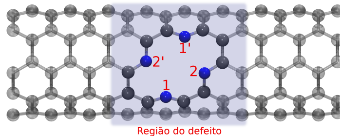
Figura 1.5: Sistema NR para o nanotubo (5,5) contendo 178 átomos. O defeito é formado pela divacância de carbono e 4 átomos de nitrogênio substitucionais. Os rótulos nos átomos de nitrogênio indicam os sítios equivalentes, 1 \equiv 1' e 2 \equiv 2' .
