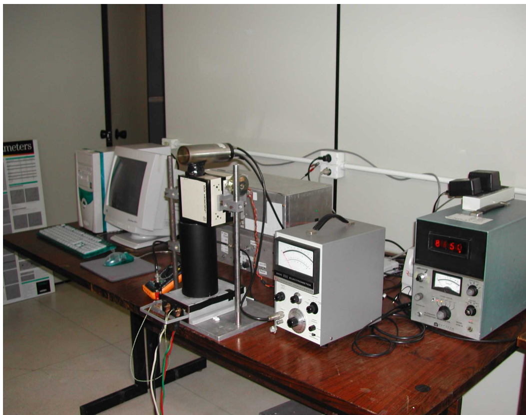
Figura 4-9 Foto do arranjo experimental do leitor TL para obtenção do espectro de emissão TL.
