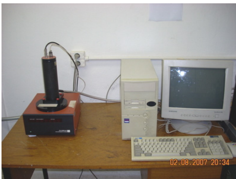
Figura 4-11 A leitora de TL Daybreak 1100 acoplado a um computador para a aquisição dos dados.
