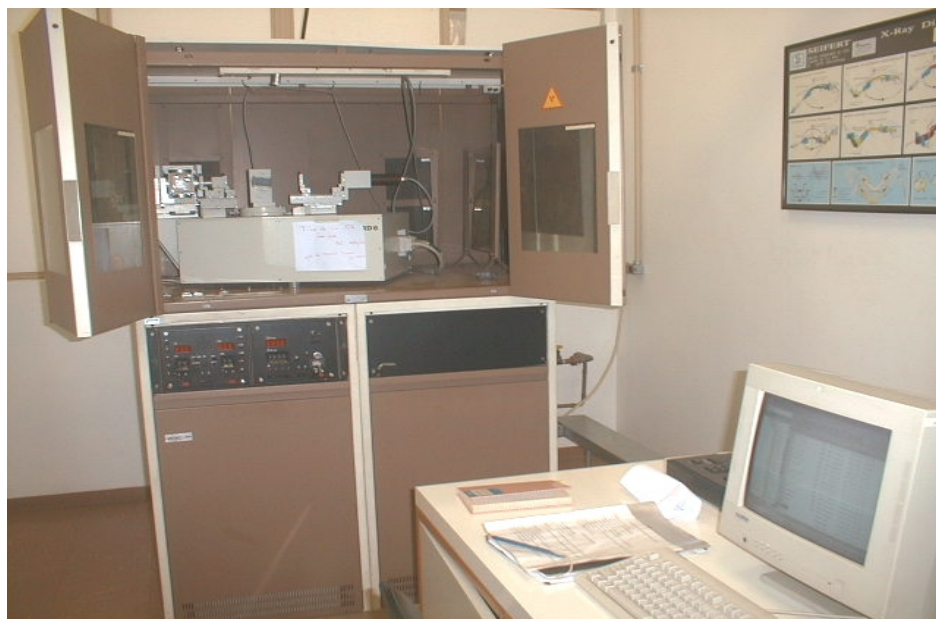
Figura 4-2 Gerador de raios X de 3 kW da Zeiss-Jena, com duas torres:(i) Difratorômetro IRIS URD-6 com geometria Theta-2Theta(ii) Câmara de Debye-Scherrer e de Laue
