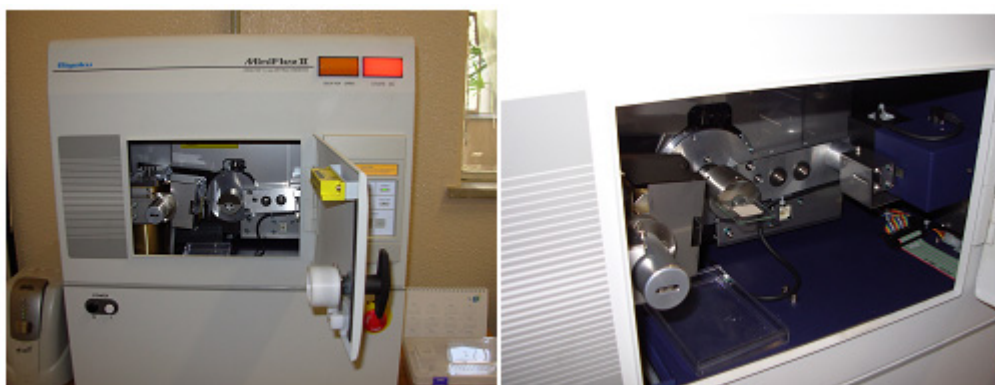
Figura 4-3 Difratorômetro de raios-X modelo MiniFlex II, fabricado pela Rigaku.
