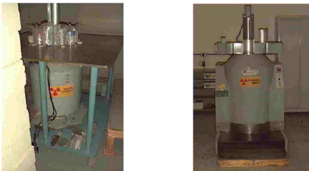
Figura 4-4 Os dois irradiadores de fonte de ^{60}\text{Co} utilizados: (a)Fonte Panorâmica, (b)fonte “Gamma Cell” do IPEN-SP
