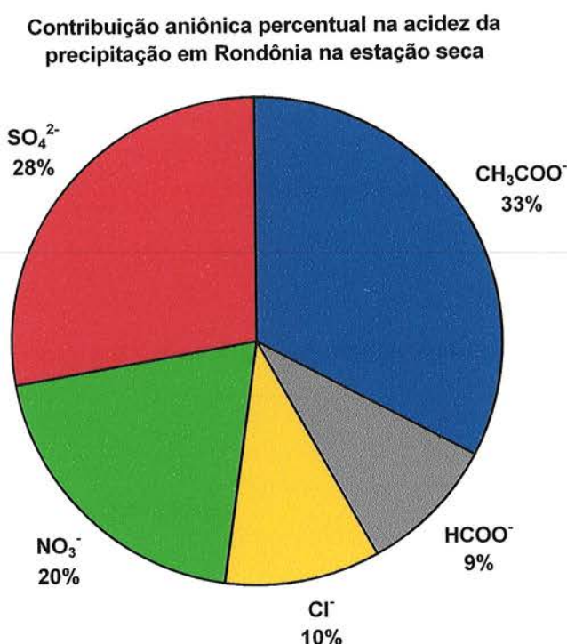
Figura 4.25: Contribuição percentual aniônica de ânions de ácidos minerais e orgânicos observada em amostras de precipitação coletadas em Rondônia durante a estação seca.
