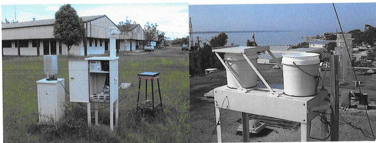
Figura 3.11: Coletores automáticos de precipitação do tipo wet-only utilizados neste trabalho. À esquerda, amostrador Ecotech (na fotografia, no sítio de Balbina); à direita, amostrador Aerochem.
